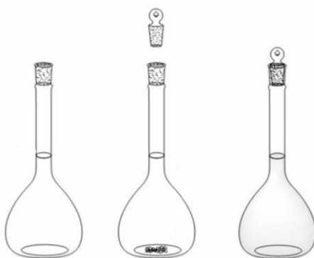
Рис. 8. Приготовление первичного стандартного раствора из кристаллического стандартного вещества
