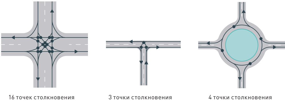
Илл. 176. Количество точек столкновения на Х-образных, Т-образных и кольцевых пересечениях
